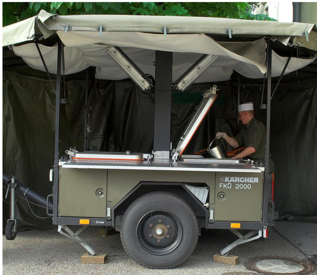
Die Feldküche 2000 kann mit dem Universalbrenner oder mit einem Feststoffbrenner betrieben werden.
